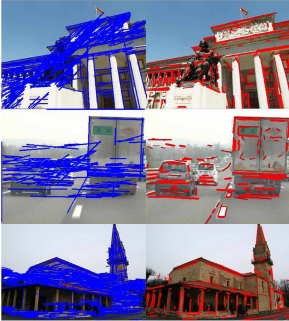
Εικόνες 2.3: Στις εικόνες αριστερά η ανίχνευση γραμμών πραγματοποιείται με το μετασχηματισμό του Hough. Στα δεξιά με τον αλγόριθμο LSWMS. [15]
