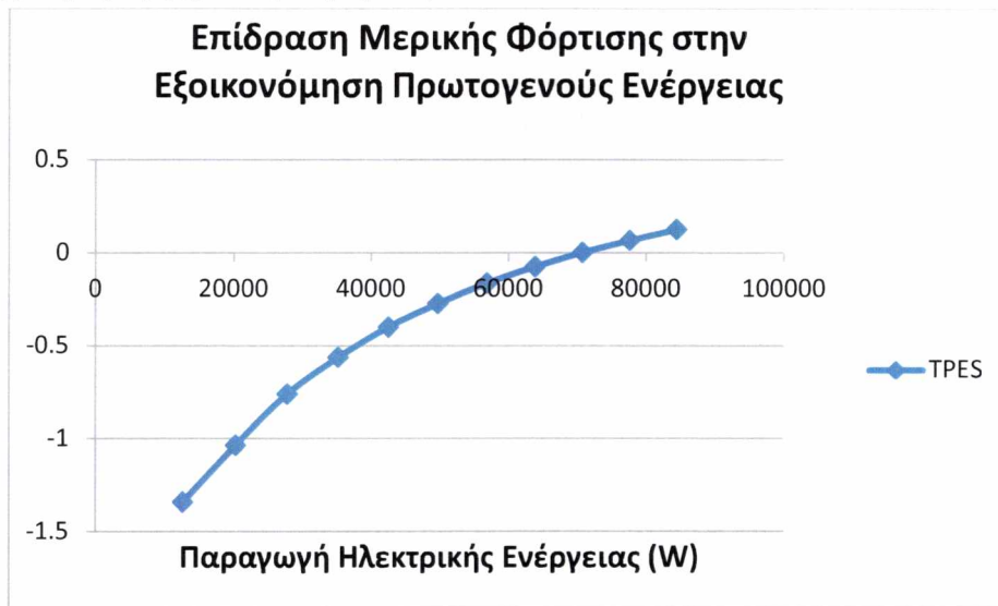
Διάγραμμα 6.9: Επίδραση Μερικής Φόρτισης στην Εξοικονόμηση Πρωτογενούς Ενέργειας με Ψύκτη μονού σταδίου –Συντελεστές Απόδοσης (λειτουργία ψύξης)
