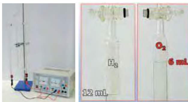
Σχήμα 4.2 Ηλεκτρολυτική διάσπαση του νερού
