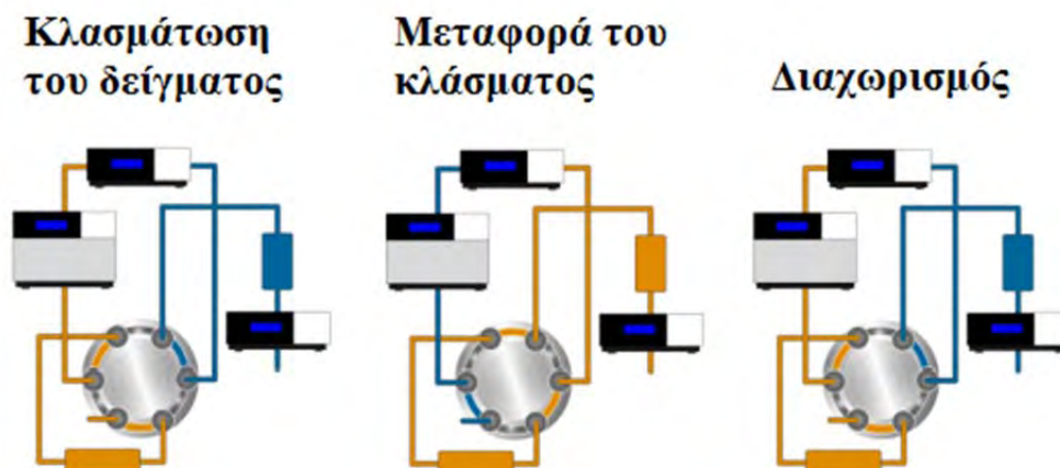
Σχήμα 3. Κύρια βήματα στην εν σειρά εκχύλιση στερεάς φάσης.
