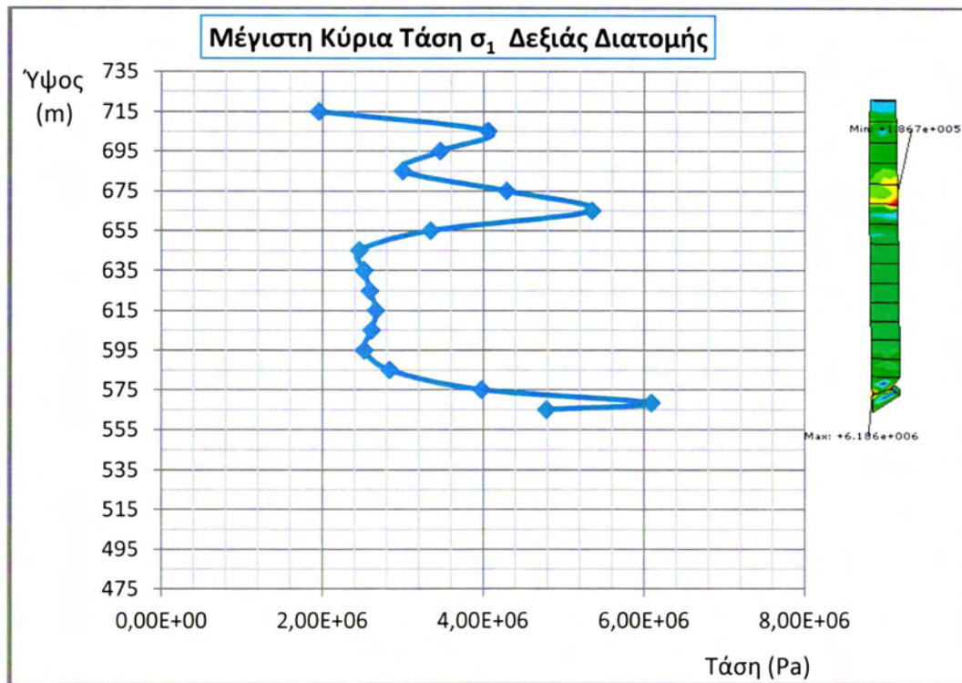
Σχήμα 6.2.12 Μέγιστη Κύρια Τάση \sigma_1 Δεξιάς Διατομής
