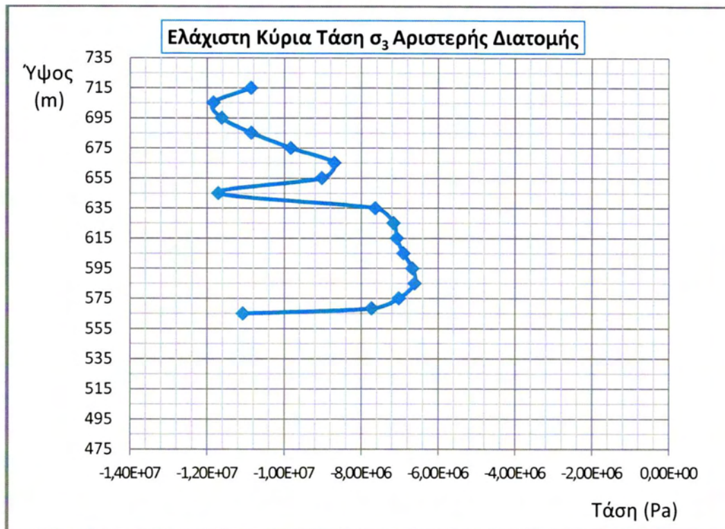
Σχήμα 5.2.20 Ελάχιστη Κύρια Τάση \sigma_3 Αριστερής Διατομής
