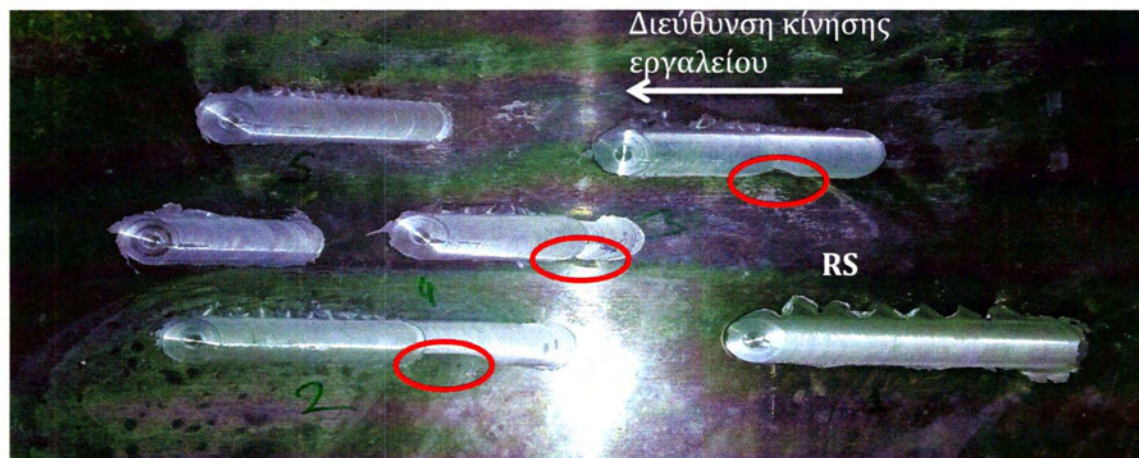
Εικόνα 4.1 – Πρώτα δοκιμαστικά περάσματα με διάφορες συνθήκες συγκόλλησης σημειώνεται η διεύθυνση κίνησης και η φορά περιστροφής του εργαλείου.
