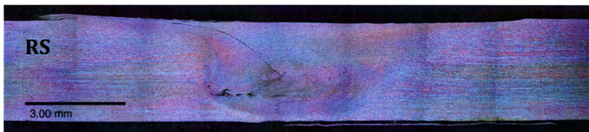
Εικόνα 4.10 – Μεταλλογραφία πρώτης μετωπικής συγκόλλησης, 800rpm 230mm/min
