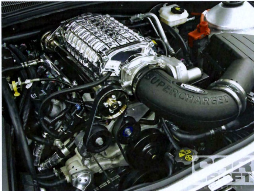
Σχήμα 1.6 Μηχανή Εσωτερικής Καύσης με Υπερπληρωτή Μηχανικής Ισχύος
