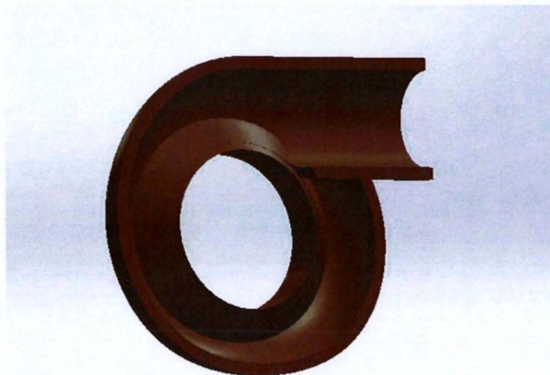
Σχήμα 4.18 Τομή τρισδιάστατου σχεδίου housing στροβίλου
