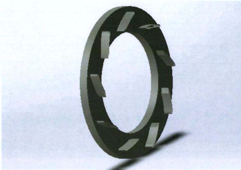
Σχήμα 4.19 Τρισδιάστατο σχέδιο στάτορα στροβίλου
