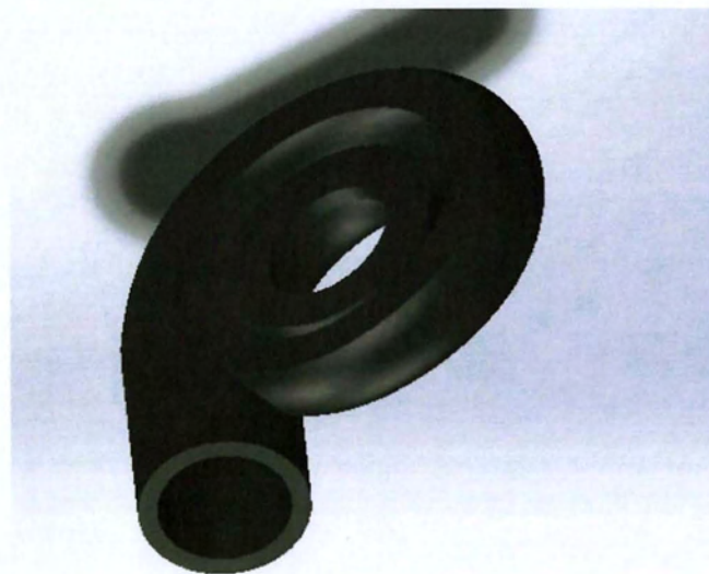
Σχήμα 4.16 Τρισδιάστατο σχέδιο housing συμπιεστή με ορατή την διόδο του αέρα
