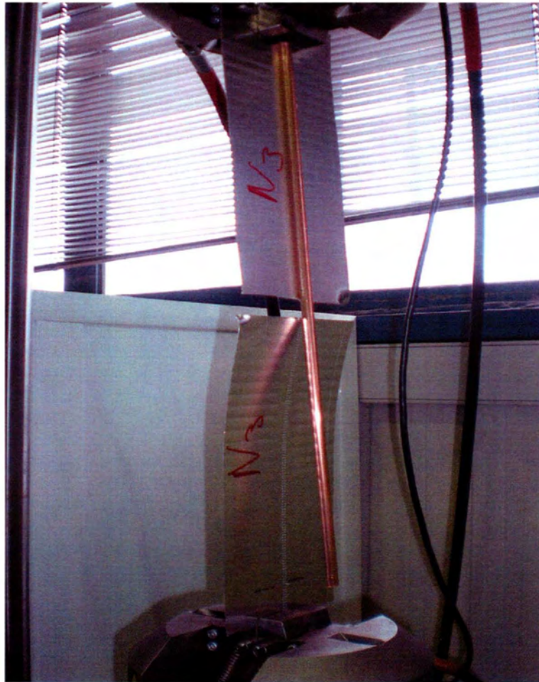
Σχήμ.3.7: Αποκόλληση των συγκολλήσεων στο κάτω μέρος του δοκιμίου μετά το τέλος της δοκιμής διάτμησης
