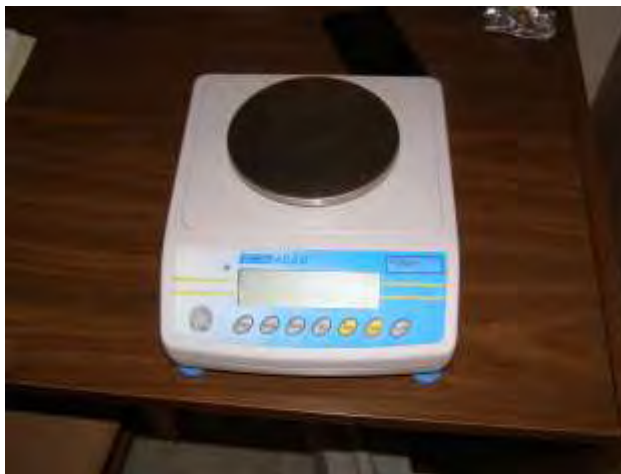
Εικόνα 24. Ζυγαριά ακριβείας μέχρι τριών δεκαδικών ψηφίων ADAM ACB plus- 150 .
