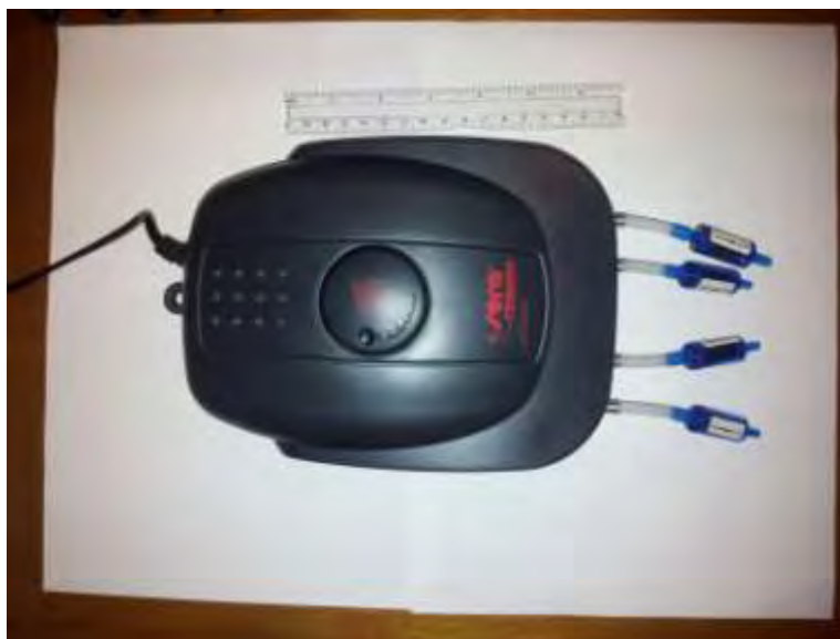
Εικόνα 16. Αεραντλία Sera air 550 R plus με τέσσερις εξόδους παροχής αέρα.
