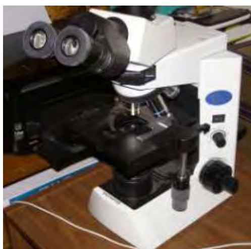
Εικόνα 22. Οπτικό μικροσκόπιο OLYMPUS CX41.
