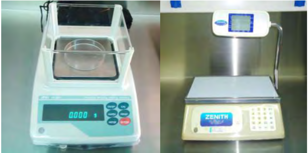
Εικ. 28: Ζυγοί ακριβείας που χρησιμοποιήθηκαν στις μετρήσεις βάρους.
