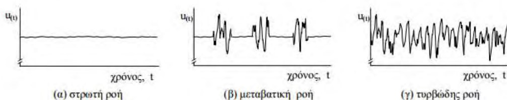
Σχήμα 22: Ποιοτικό διάγραμμα ταχύτητας-χρόνου για κάθε είδος ροής.
