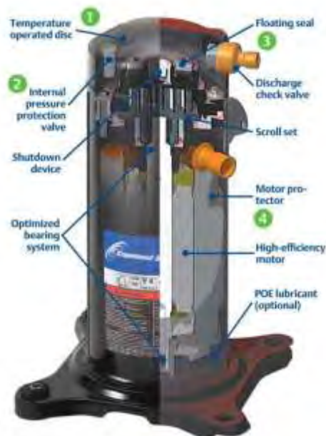
Εικόνα 1-4: Συμπιεστής τύπου scroll για αντλία θερμότητας
