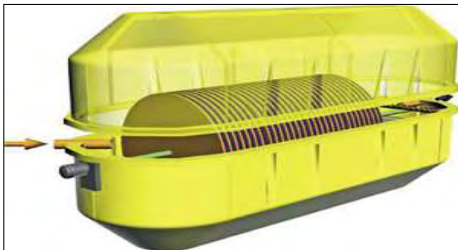
Εικόνα 4-6: Βιολογικός δίσκος που χρησιμοποιείται για την επεξεργασία λυμάτων.( © 2017 - SHIELCO Τεχνολογίες Περιβάλλοντος ΕΠΕ)
