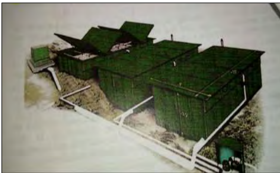
Εικόνα 4-5: Μονάδα βιολογικών φίλτρων με πλήρωση συνθετικού υφάσματος.
