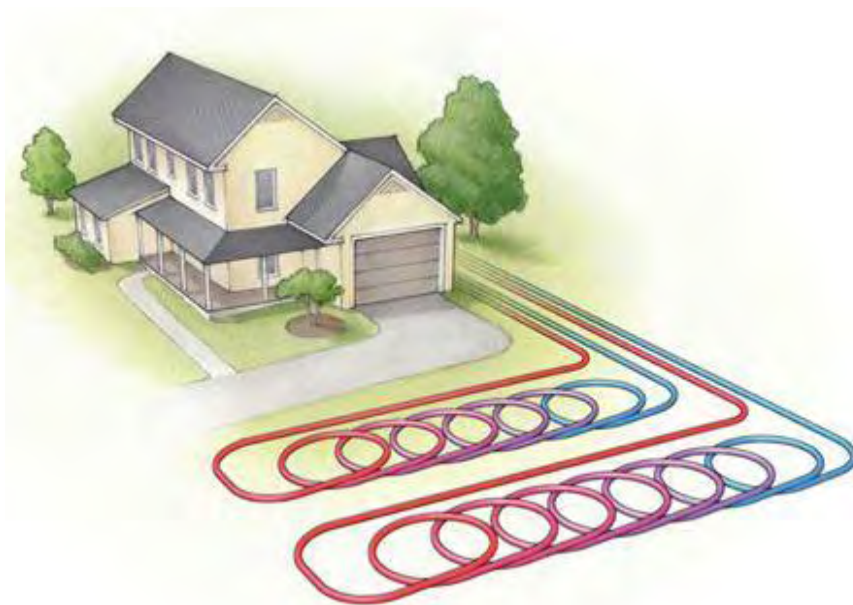
Σχήμα 11: Γεωθερμικό κύκλωμα Αντλίας Θερμότητας ( thermansinews.blogspot.gr )
