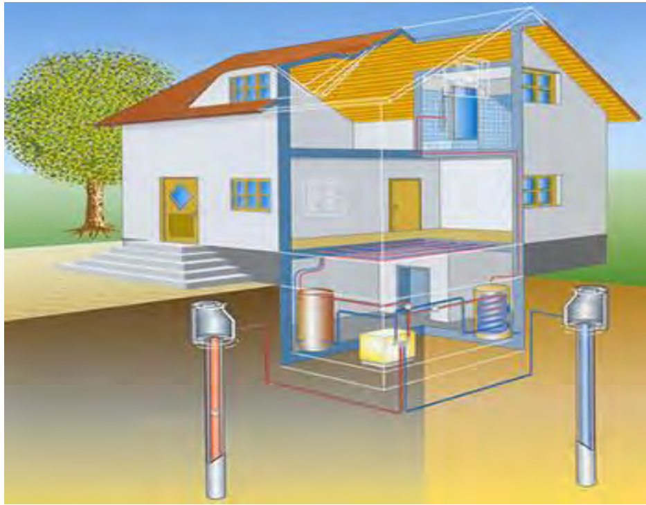
Σχήμα 12: Ανοικτό Γεωθερμικό Σύστημα οικιστικό ( http://geoergo.gr/geothermia_egkatastasi.html )
