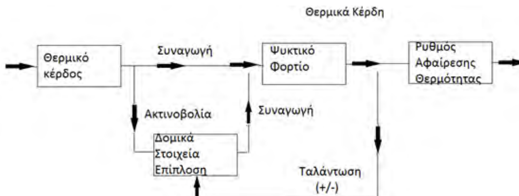
Σχήμα 15: Στιγμαίο θερμικό κέρδος, ψυκτικό φορτίο και ρυθμός αφαίρεσης θερμότητας σε ένα χώρο
