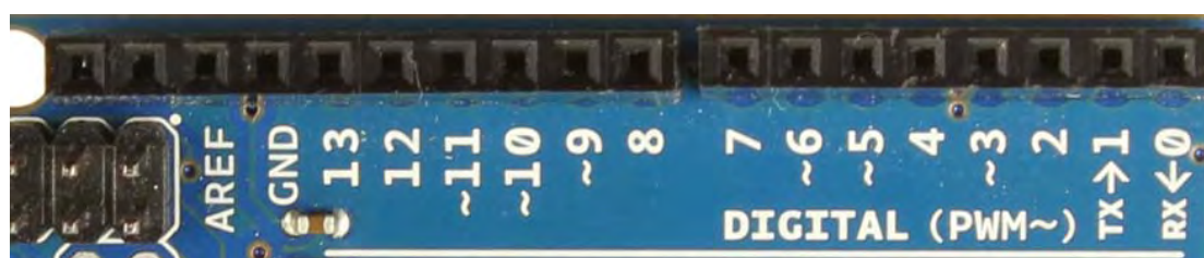
Εικόνα 5.5 : Τα 14 ψηφιακά ports στο Arduino Uno. Παρατηρήστε ότι τα δύο πρώτα αφορούν τις ψηφιακές επικοινωνίες.
