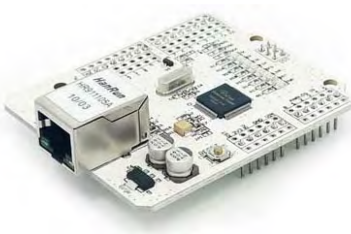
Εικόνα 8-6 : Μια πλακέτα Ethernet της SeedStudio βασισμένη στον επεξεργαστή Wiznet W5100 (Η εικόνα είναι ιδιοκτησία της SeedStudio).
