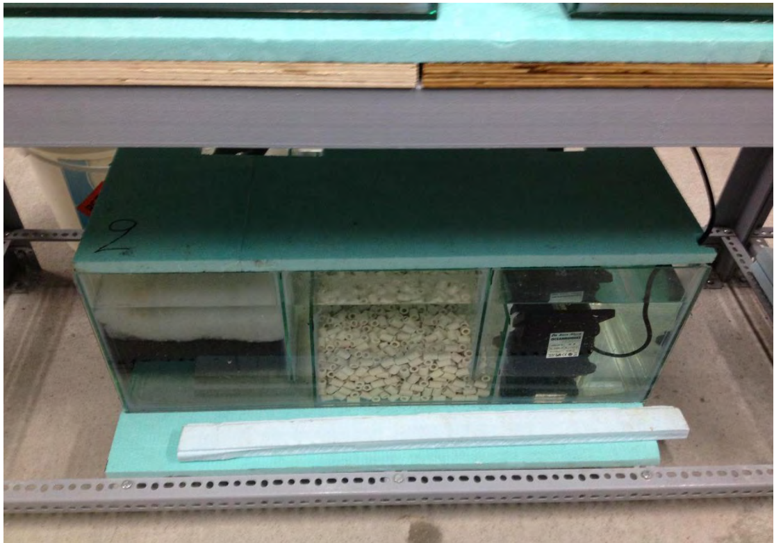
Εικόνα 2.2: Άποψη του εξωτερικού φίλτρου (μηχανικού & βιολογικού) που χρησιμοποιήθηκε κατά τη διάρκεια της παρούσας έρευνας (Neofitou et al. 2016).
