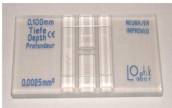
Εικόνα 14: αντικειμενοφόρος πλάκα Neubauer
