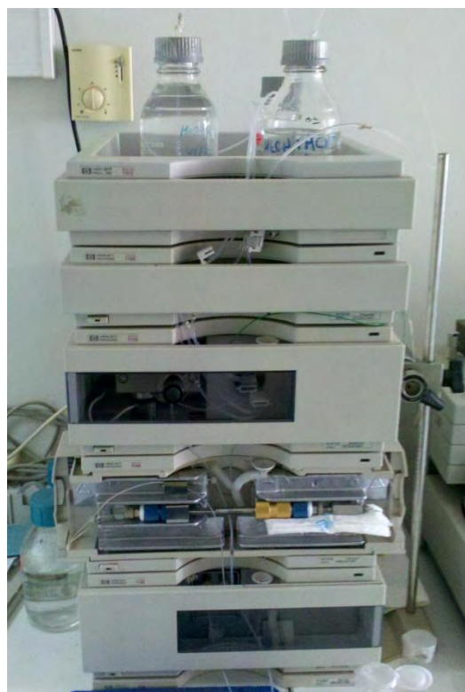
Εικόνα 13. Χρωματογραφικό σύστημα HPLC με ανιχνευτή UV-VIS.
