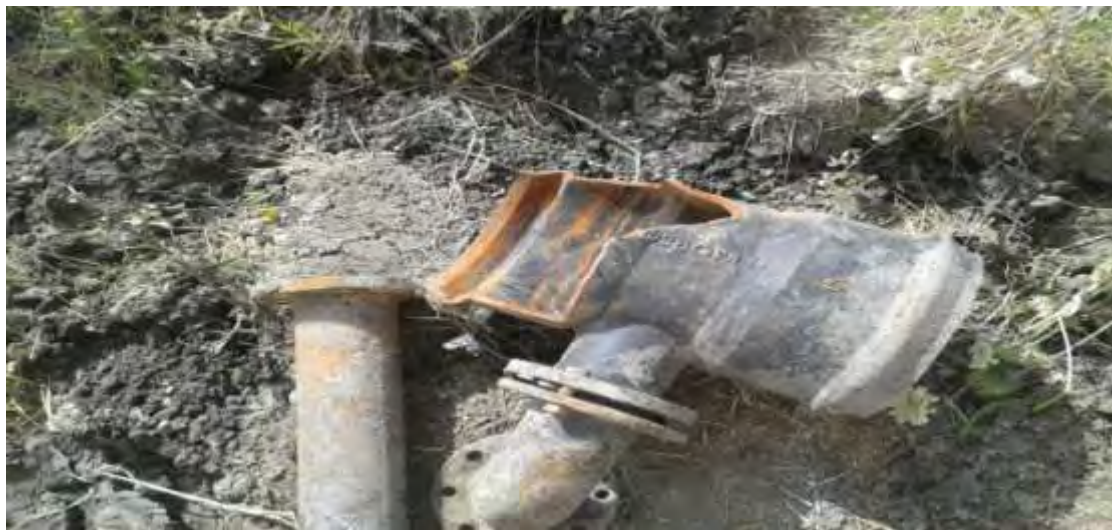
Εικόνα 5.3 βλάβη 3 η σπάσιμο συστολικο ταφ στη ζώνη Σ2
