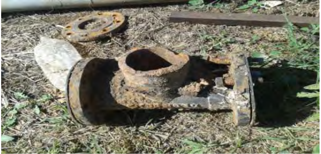
Εικόνα 5.28 βλαβη 2η σπάσιμο συστολικού ταφ στη ζώνη Σ3
