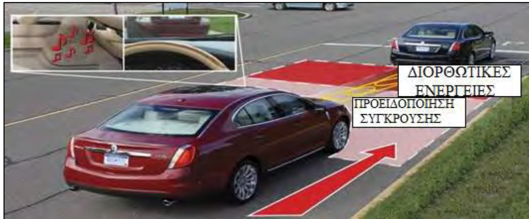
ΕΙΚΟΝΑ 17:Οι φάσεις λειτουργίας του συστήματος αποφυγής σύγκρουσης [40].
