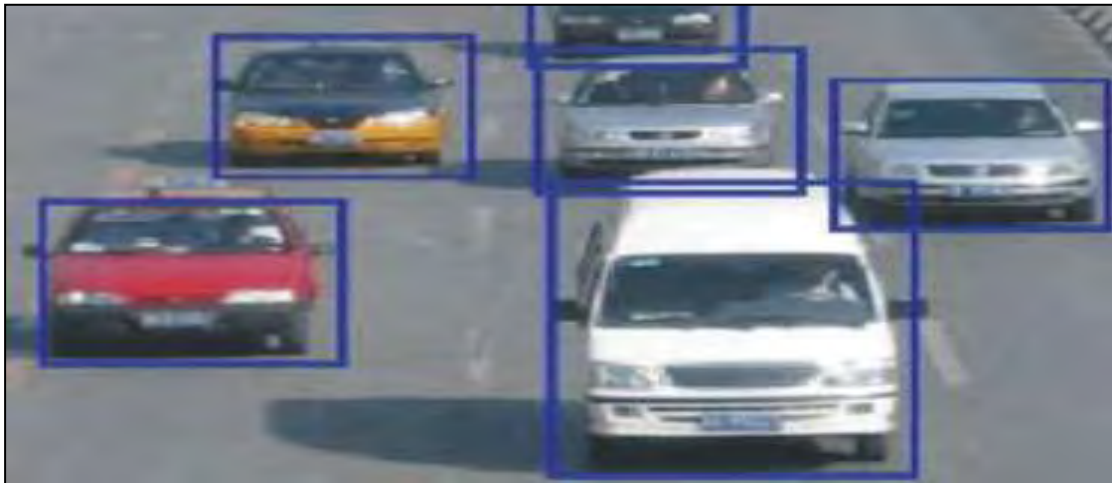
ΕΙΚΟΝΑ 9:Ανίχνευση οχημάτων με χρήση βιντεοκάμερας[28].
