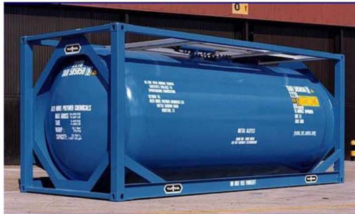
Εικόνα 7. Εμπορευματοκιβώτιο υγρών χύδην φορτίων και συμπιεσμένων αερίων
