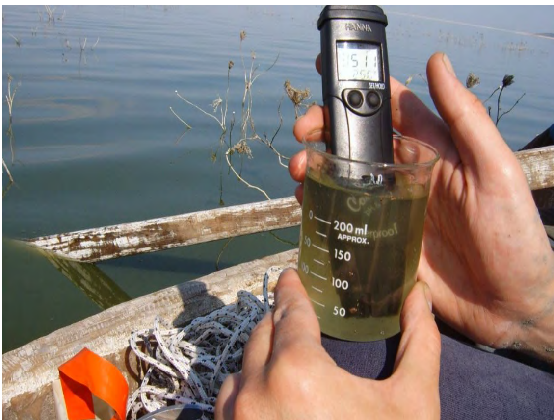
Εικόνα 2.4: Ειδικό φορητό όργανο μέτρησης αγωγιμότητας και TDS (Combo by Hanna).
