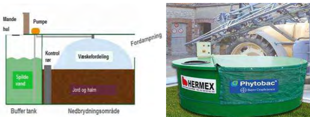
Εικόνα 2. Ένας τύπος βιοκλινών (Phytobac®) που χρησιμοποιούνται στην Γαλλία για την επεξεργασία υγρών αποβλήτων που παράγονται στον αγρό από μη ορθολογικές πρακτικές πριν ή μετά τον ψεκασμό Πηγή: © Bayer Nordic, 2013
