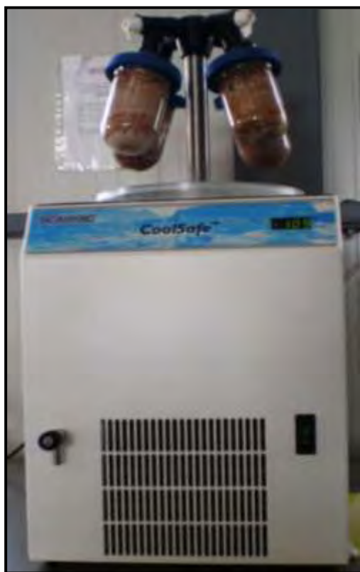
Εικόνα 8: Η Συσκευή FreezeDryer που Χρησιμοποιήθηκε, για την Παρασκευή των Δειγμάτων.
