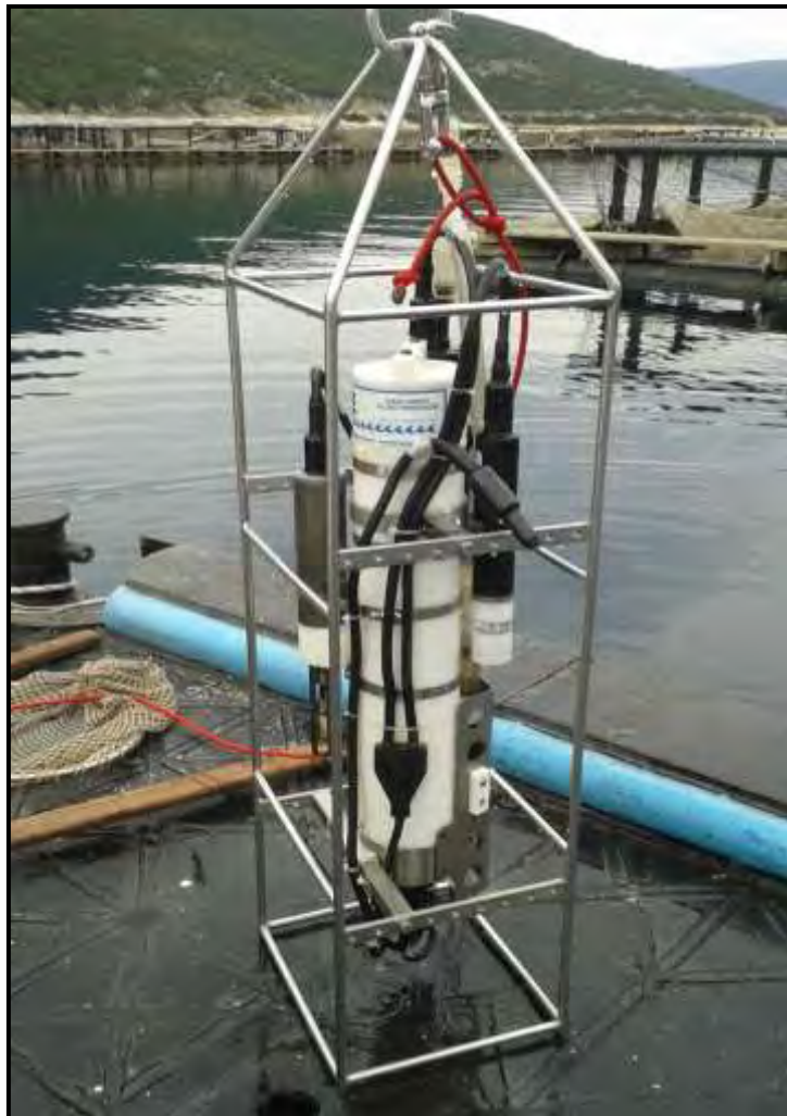
Εικόνα 2.6. Συνεχής καταγραφέας (CTD) φυσικοχημικών παραμέτρων του νερού (SEABIRD-19plus).
