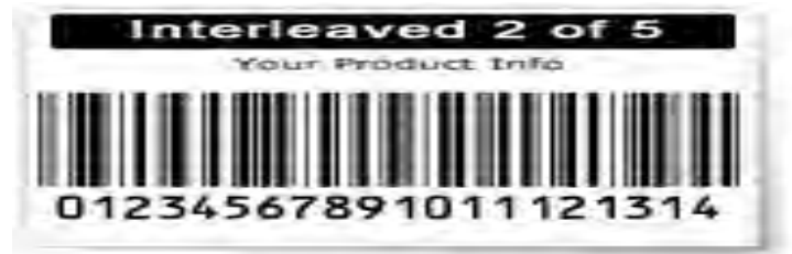
Εικόνα 5: Ο γραμμωτός κώδικας INTERLEAVED 2 of 5
