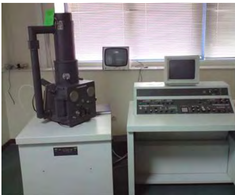
Εικόνα 2.2. Το ηλεκτρονικό μικροσκόπιο σάρωσης Cambridge Stereo Scan 240 του Τμήματος Γεωπονίας Ιχθυολογίας και Υδάτινου Περιβάλλοντος.
