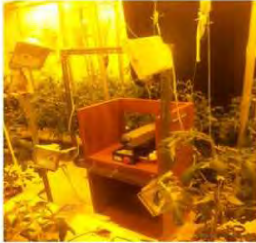
Εικόνα 17. Θέση υπερφασματικού αισθητήρα απεικόνισης αποτελούμενο από την υπερφασματική κάμερα, το περιστρεφόμενο σύστημα σάρωσης και το πλαίσιο λαμπτήρων αλογόνου, μέσα στο θάλαμο ελεγχόμενων συνθηκών.
