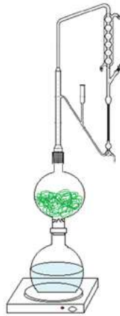
Εικόνα 2. 4: Απόσταξη με ατμό με αποστακτική διάταξη τύπου Clevenger
