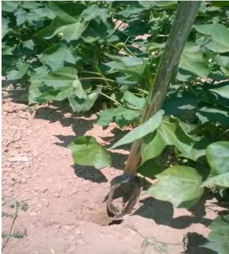
Εικόνα 3.7: Ανοιγμα οπής στο έδαφος για τοποθέτηση των αισθητήρων Decagon 10HS με τη χρήση εδαφολήπτης ξηρού εδάφους
