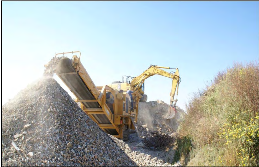
Εικόνα 2.4: Στάδια επεξεργασίας ΑΕΚΚ (Αλαβέρας, 2012)
