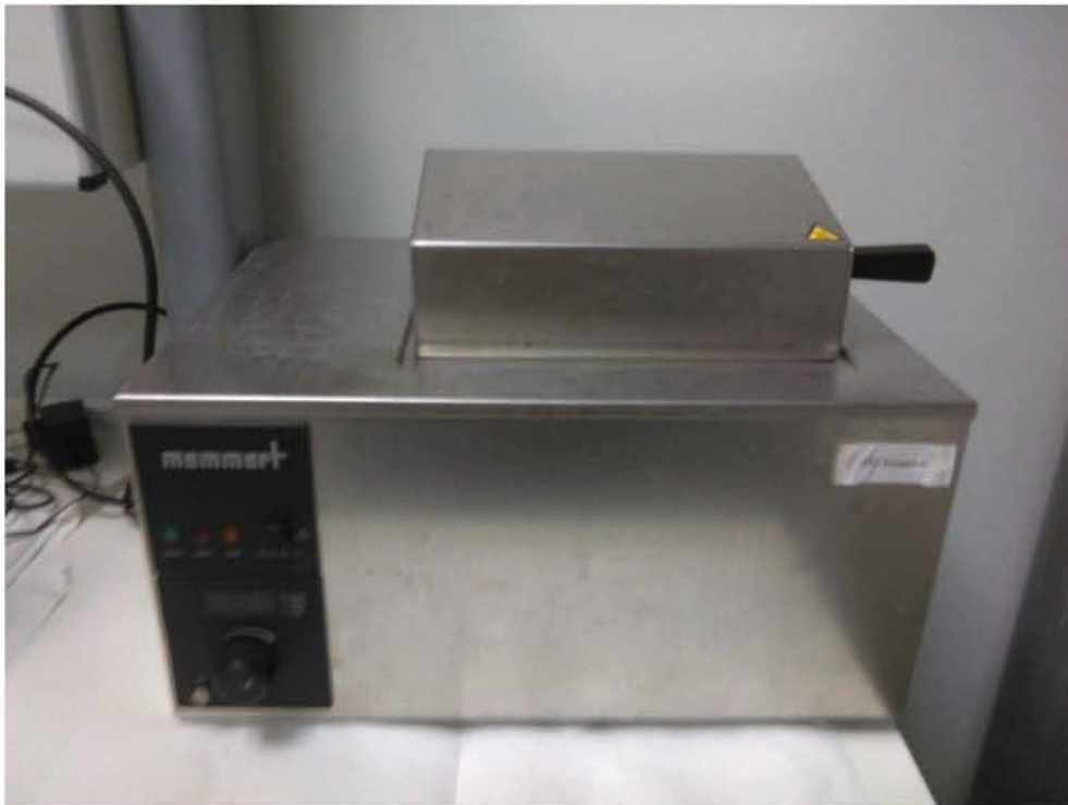
Εικόνα 1: Υδατόλουτρο που χρησιμοποιήθηκε στη διαδικασία του πειράματος
