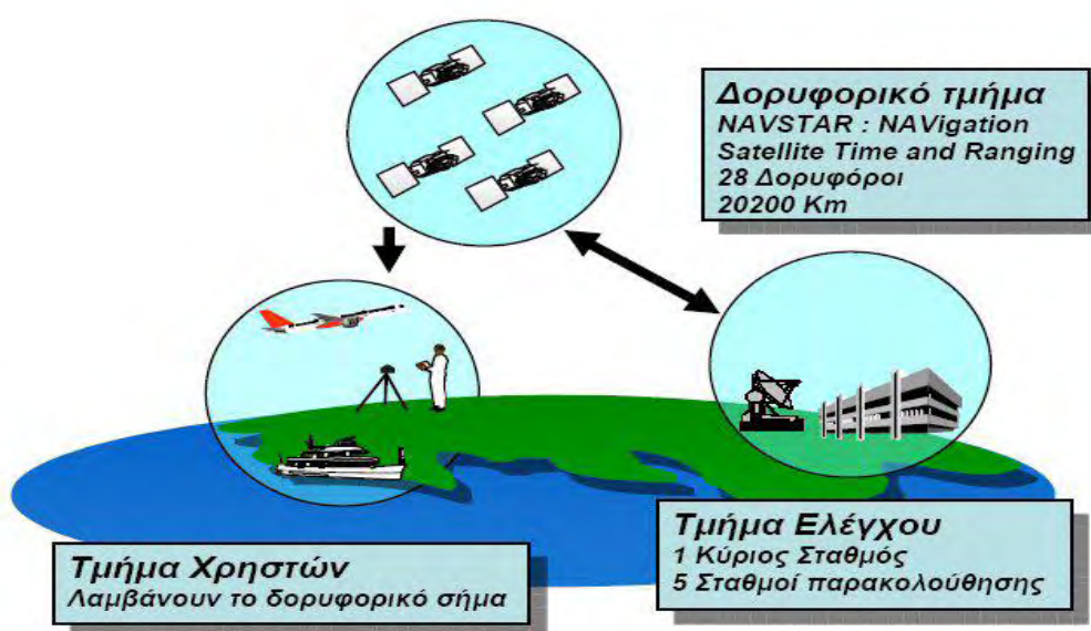
Εικόνα 1. Τα κύρια μέρη από τα οποία αποτελείται το GPS (Πηγή: Δερμάνης 1999).
