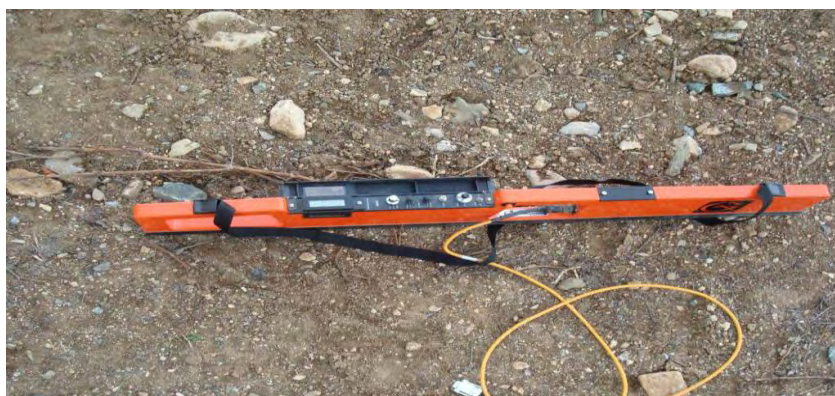
Εικόνα 7. Απεικόνιση αισθητήρα EM-38 (Geonics Ltd., Mississauga, Ontario, Canada).
