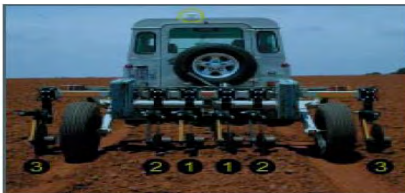
Εικόνα 8. Το μηχάνημα χαρτογράφησης της ηλεκτρικής αγωγιμότητας Veris 3100(Πηγή: Παπαοικονόμου 2003).
