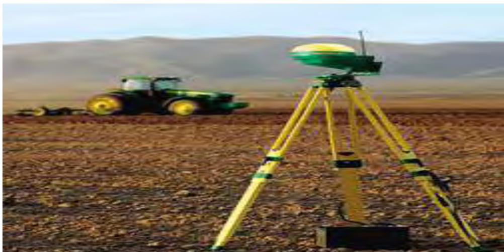
Εικόνα 5. Επίγειος σταθμός RTK στο χωράφι.
