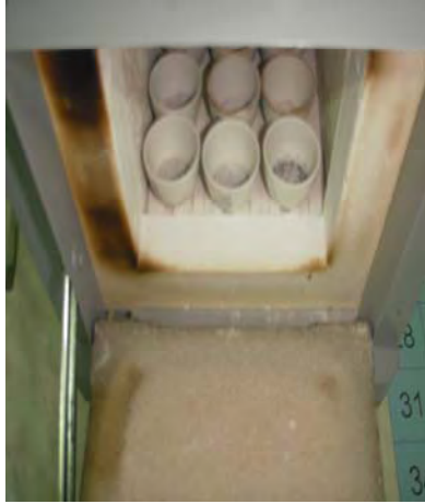
Εικόνα 17. Δείγματα μετά από 4 ώρες στον κλίβανο στους 550°C.
