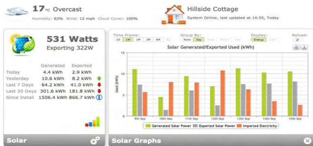
Εικόνα 2. Σύστημα παρακολούθησης και έλεγχου της ηλεκτρικής ενέργειας.
