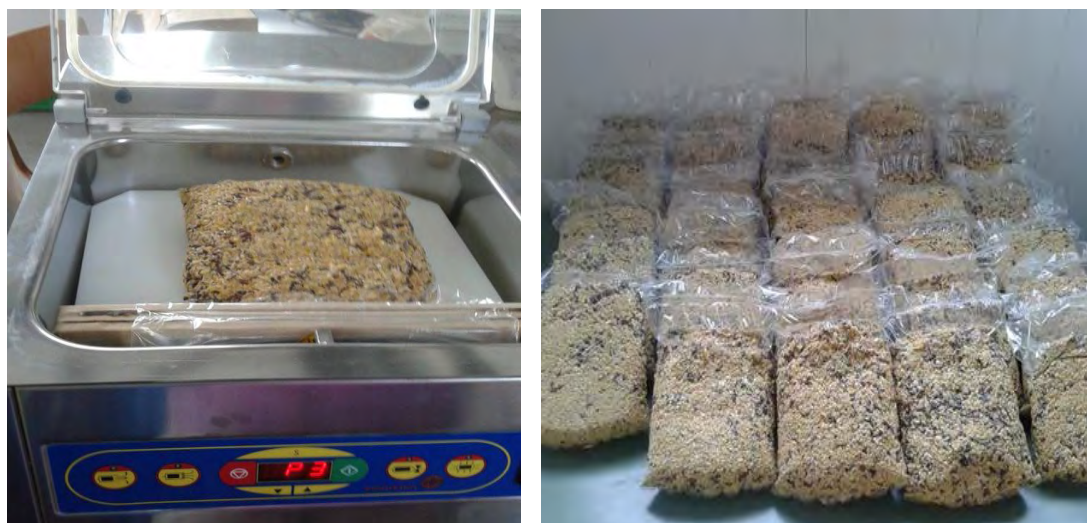
Εικόνα 4: Διαδικασία συσκευασίας του ενσιρώματος στεμφύλων.
