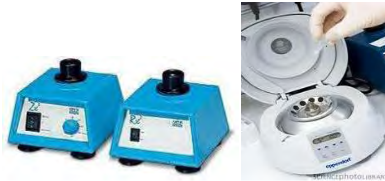
Εικόνα 17: Συσκευές ανάδευσης vortex και στροβιλισμού spin
