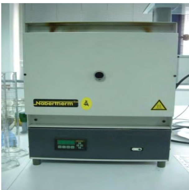
Εικόνα 2.5.4. Αποτεφρωτήρας για τον προσδιορισμό της τέφρας στα σιτηρέσια.
