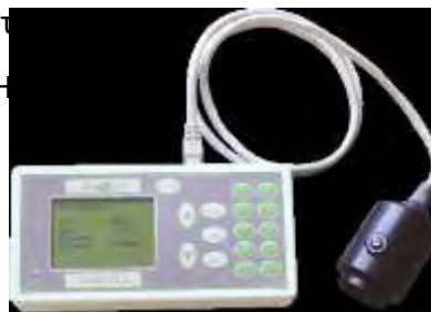
Εικόνα 14. Handy PEA για τις μετρήσεις του επαγωγικού φθορισμού
