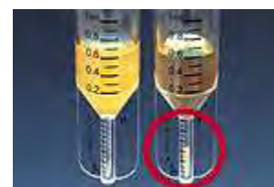
Εικόνα 12. Διαβαθμισμένοι σωλήνες PCV
