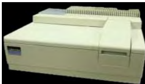
Εικόνα 13. Φασματοφωτόμετρο UV/VIS (PERKIN ELMER lambda 20)
