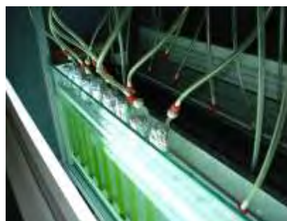
Εικόνα 8. Σύστημα προκαλλιέργειας του χλωροφύκου Scenedesmus obliquus
