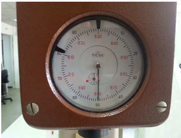
Εικόνα 20 Μετρητής του σκληρόμετρου Frank σε "νεκρή" θέση. Ο εξωτερικός δακτύλιος τιμών είναι η κλίμακα Rockwell C, ενώ στο κεντρο διακρίνεται ο μικρότερος μετρητής για τη σωστή τοποθέτηση του εντυπωτή.
