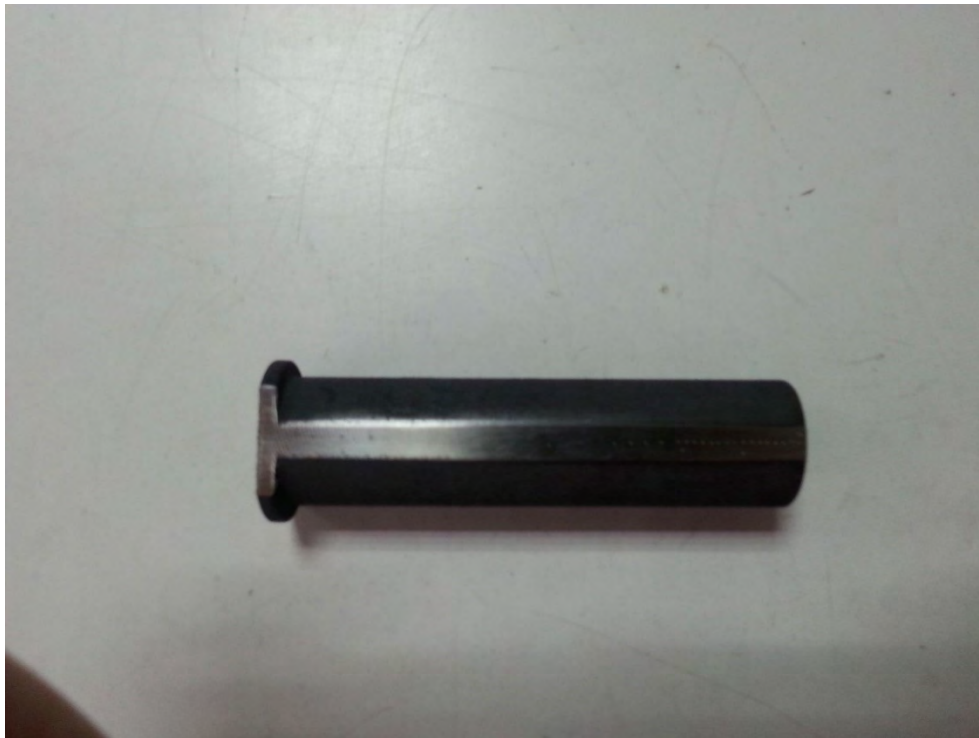
Εικόνα 18 Δοκίμιο μετά τη διαμόρφωση των επιπέδων και τη λείανση.
