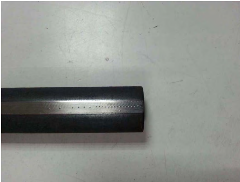
Εικόνα 19 Δοκίμιο μετά τις μετρήσεις με εμφανή τα σημάδια του εντυπωτή.
