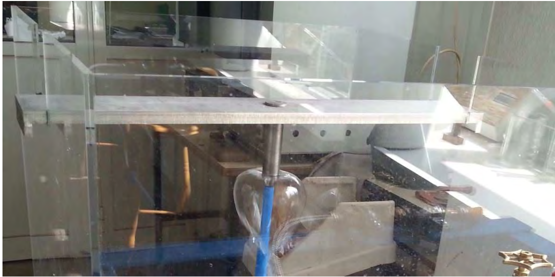
Εικόνα 16 Πραγματοποίηση ελέγχου πριν την εκκίνηση των πειραμάτων με τη χρήση δοκιμίου “dummy”. Φαίνεται καθαρά το σχήμα «ομπρέλας» που παίρνει ο πίδακας χτυπώντας το δοκίμιο, όταν όλη η διάταξη είναι σωστή.
