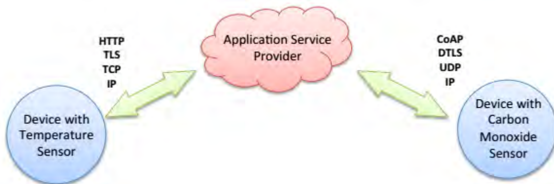
Εικόνα 7 Device-to-Cloud Μοντέλο Πηγή: The Internet of Things: An Overview, Rose et'al
