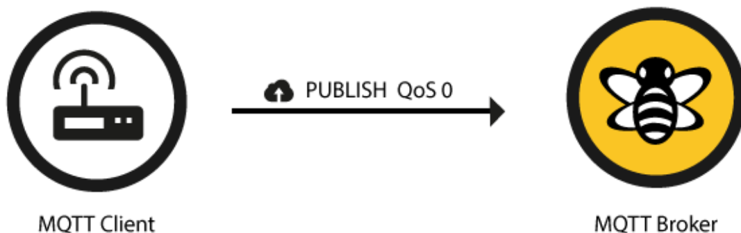
Εικόνα 26 Μετάδοση Μηνύματος με QoS-0 Πηγή: HiveMQ –MQTT Essentials
