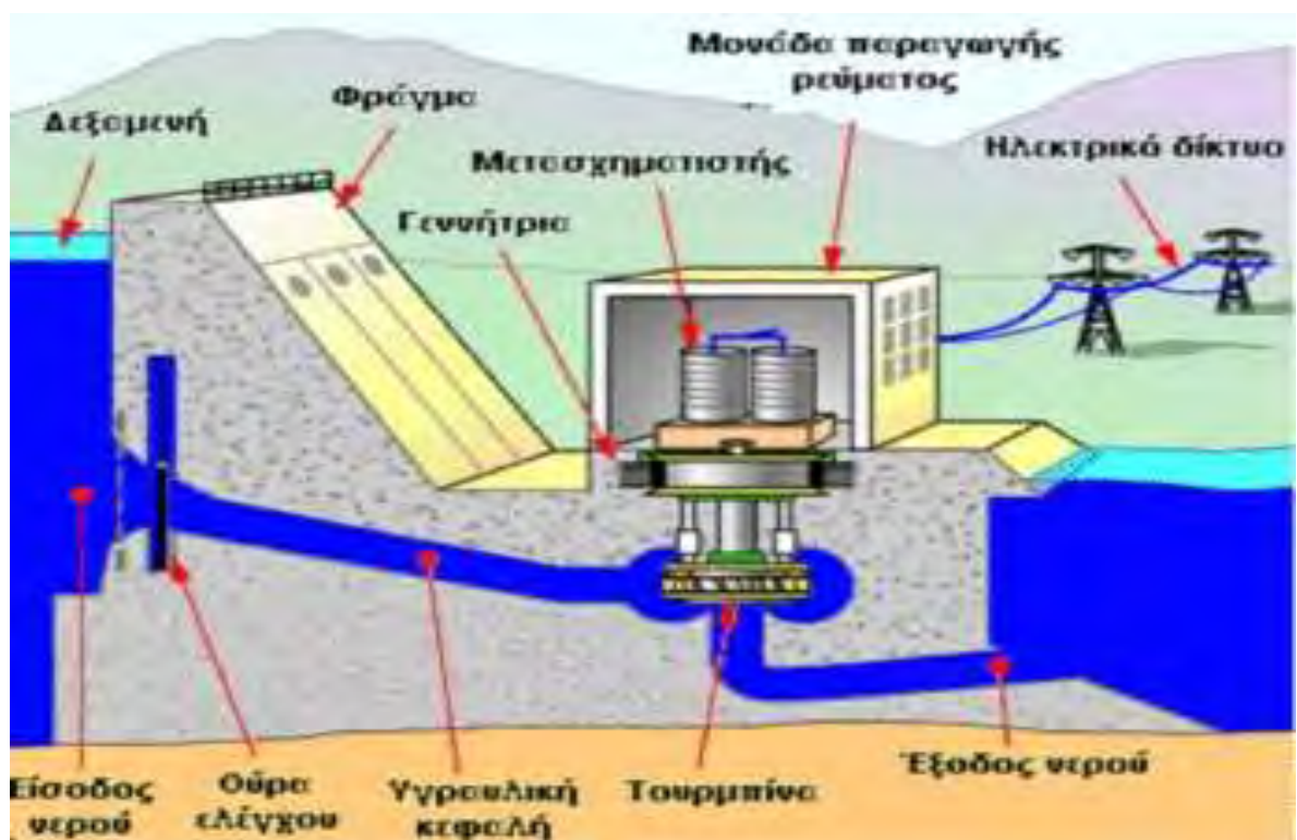
ΕΙΚΟΝΑ 2: Διαδικασία μετατροπής Υδροηλεκτρικής Ενέργειας
