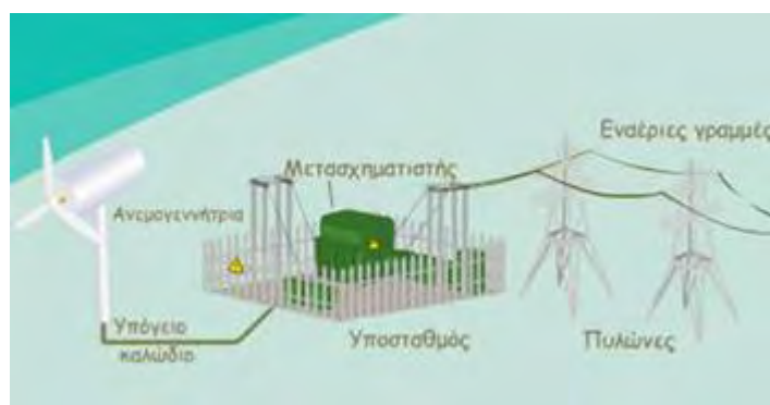
Εικόνα 10: Δομή Συστήματος Παραγωγής Ενέργειας με Ανεμογεννήτρια [6]
