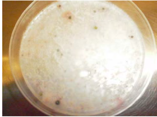
Εικόνα 24. Ανάπτυξη μυκήτων σε τριβλία με θρεπτικό μέσο DG 18 όπου είχε τοποθετηθεί διάλυμα πεπτόνης και αραβοσιτάλευρο περιεκτικότητας 10^{-1} g/ml
