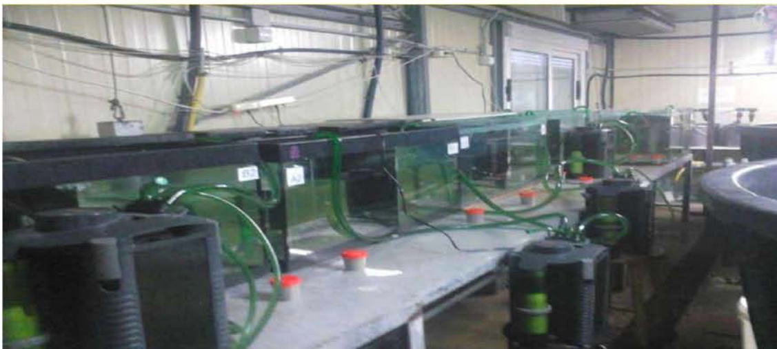
Εικόνα 2.2: Διάταξη δεξαμενών και απεικόνιση του συστήματος φιλτραρίσματος-αποστείρωσης (φωτογραφία συγγραφέα).
