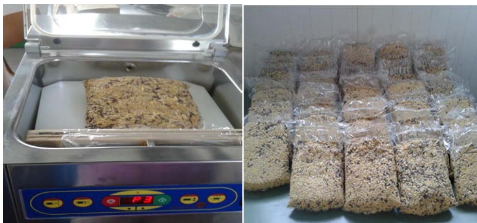
Εικόνα 32: Διαδικασία συσκευασίας του ενσιρώματος στεμφύλων.
