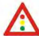
Κ-21 Προσοχή, κάμπος ή θέση όπου η κυκλοφορία ρυθμίζεται με τριχρωμή φωτεινή σηματοδότηση.
