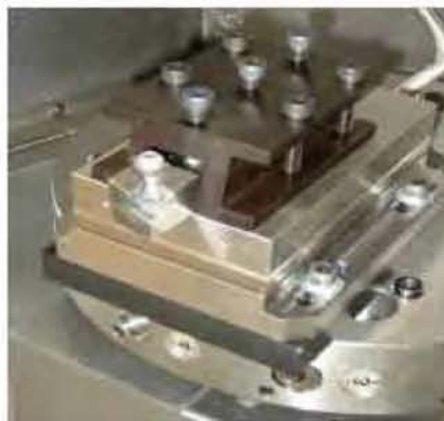
Σχήμα 7.1: Διάταξη δυναμομέτρου και εργαλείου κοπής.
