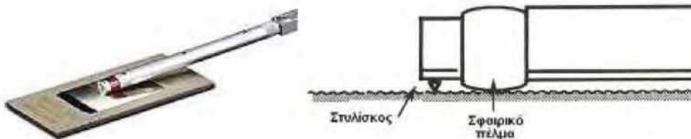
Σχήμα 6.21: Μετακινούμενο στέλεχος-στυλίσκος (αισθητήρας) του τραχυμέτρου Surtronic 3+.
