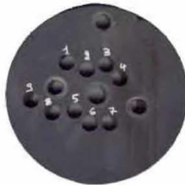
Σχήμα 9.1: α) Διάταξη δραπάνου-δυναμομέτρου β) Κατεργασμένο δοκίμιο και οπές πειραμάτων (οι οπές χωρίς αρίθμηση χρησιμεύουν για την στήριξη του δοκιμίου στο δυναμόμετρο).
