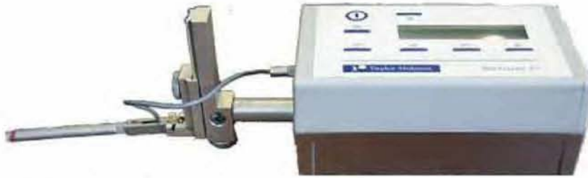
Σχήμα 6.20: Τραχύμετρο τύπου στυλίσκου Surtronic 3+ (Taylor-Hobson).
