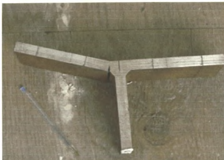
Σχήμα 3.4.1. Χαρακτηριστική ρωγμή που οδηγεί στην τελική αστοχία του δοκιμίου.
