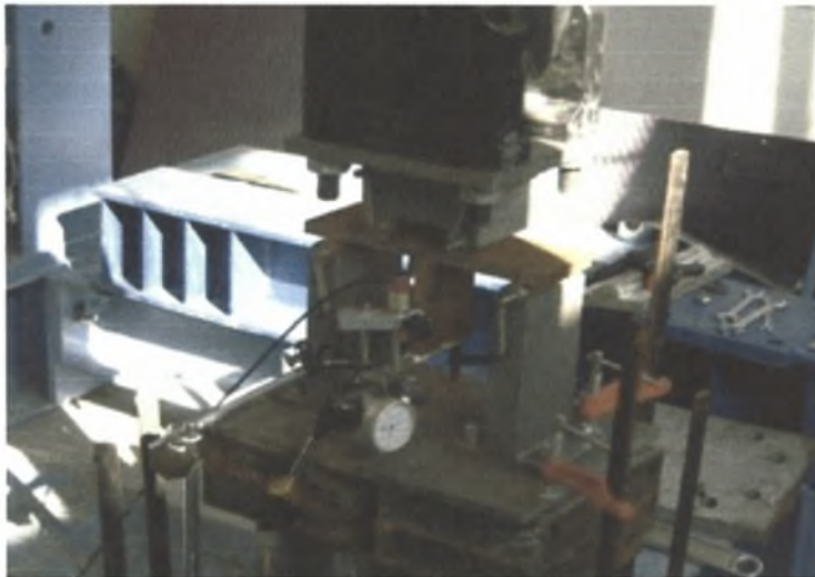
Σχήμα 3.3.2. Θέση μηχανοσκόπευτρον τύπου DCDT που χρησιμοποιήθηκε για τη μέτρηση του μέγιστου βέλους κάμψης στα δοκίμια.
