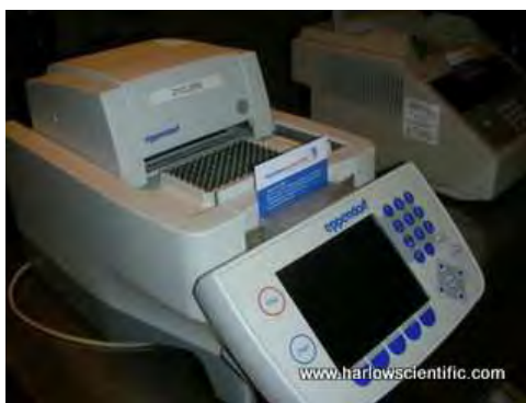
Εικόνα 3.2.4.1.: Θερμοκυκλοποιητής που χρησιμοποιείται για την αντίδραση PCR.
